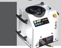
Com esta máquina, as barras de cobre de 120x12MM (160x10MM sob pedido) podem ser facilmente dobradas usando um cilindro universal, e furos de Ø 6,6 a 21,5MM, incluindo furos longitudinais, podem ser efectuados através do simples uso de punções.
